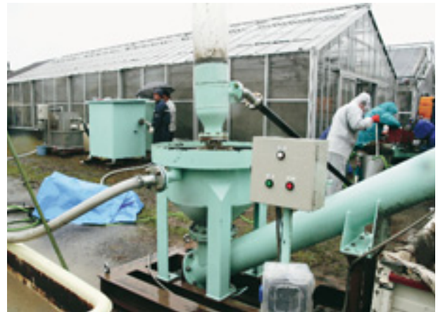
図3 試作した微細粒子除去装置の試験運転
